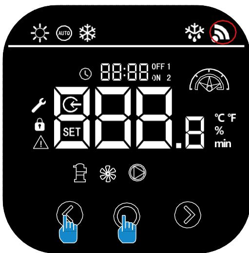
Drücken Sie + gleichzeitig für 5s, blinkt schnell, die Steuerbox ist bereit zum Pairing.
