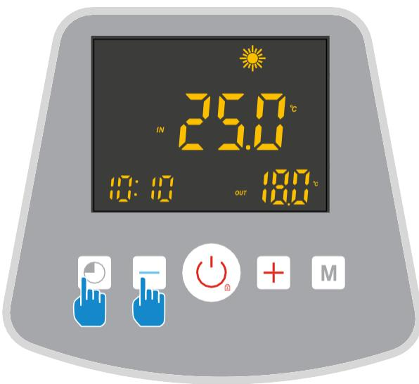
Drücken Sie + gleichzeitig für 5s, blinkt schnell, die Steuerbox ist bereit zum Pairing.
