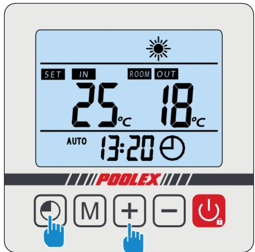
Appuyez sur + simultanément pendant 5s, le voyant clignote rapidement, le boîtier de commande est prêt à être appairé.
