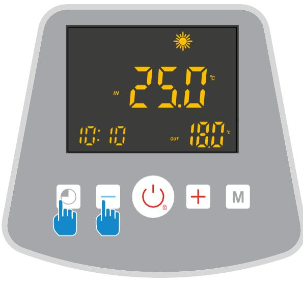
Druk tegelijkertijd 5 seconden op + , knippert snel, de besturingseenheid is klaar om te worden gekoppeld.
