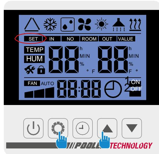
Appuyez sur + simultanément pendant 3s, le voyant clignote rapidement, le boîtier de commande est prêt à être appairé.
