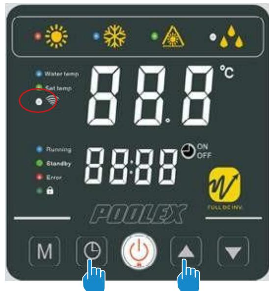
Druk tegelijkertijd 5 seconden op + , knippert snel, de besturingseenheid is klaar om te worden gekoppeld.
