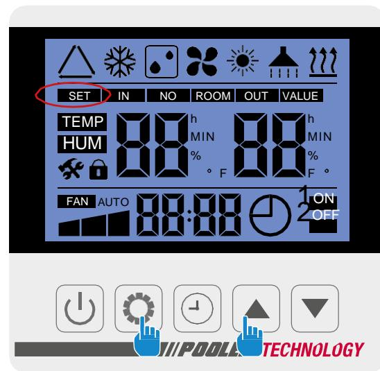
Druk tegelijkertijd 3 seconden op + , knippert snel, de besturingseenheid is klaar om te worden gekoppeld.
