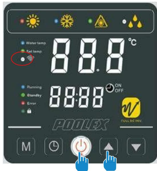
Appuyez sur + simultanément pendant 3s, le voyant clignote rapidement, le boîtier de commande est prêt à être appairé.
