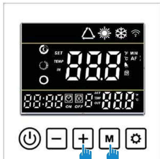
Druk tegelijkertijd 5 seconden op + , knippert snel, de besturingseenheid is klaar om te worden gekoppeld.
