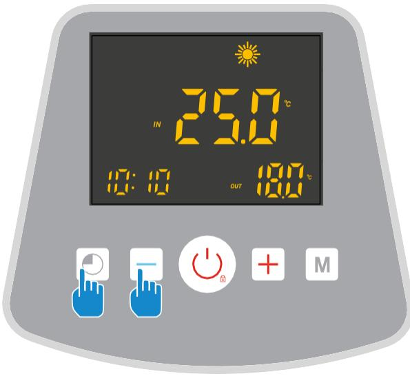
Appuyez sur + simultanément pendant 5s, le voyant clignote rapidement, le boîtier de commande est prêt à être appairé.
