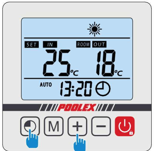
Drücken Sie + gleichzeitig für 3s, blinkt schnell, die Steuerbox ist bereit zum Pairing.
