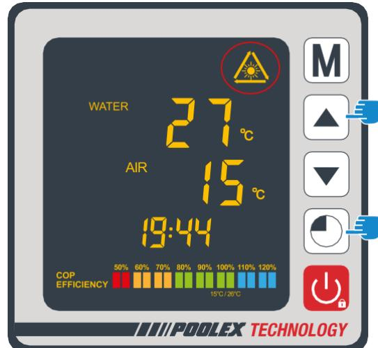
Drücken Sie + gleichzeitig für 3s, blinkt schnell, die Steuerbox ist bereit zum Pairing.
