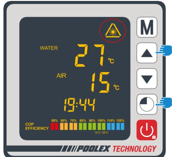
Druk tegelijkertijd 5 seconden op + , knippert snel, de besturingseenheid is klaar om te worden gekoppeld.
